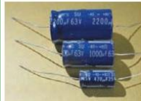
24.4 Los capacitores comerciales están rotulados con el valor de su capacitancia. Para estos capacitores, C = 2200 \mu\text{F} , 1000 \mu\text{F} y 470 \mu\text{F} .
